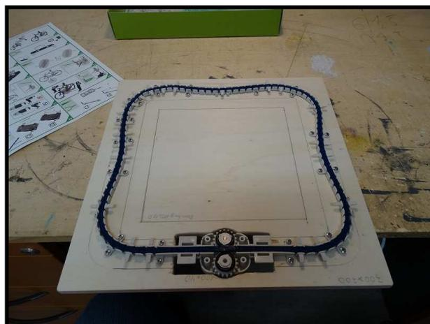
Die bisher ungenutzte Fläche der Grundplatte wird komplett mit 8 mm Balsaholz (Platten und Leisten) belegt, so dass eine nahezu ebene Fläche entsteht mit möglichst wenigen Aussparungen. Nicht benötigte Auflageflächen an der Kettenführung können abgeschnitten werden. Jetzt kann die Kette mit den eingebauten Magneten eingelegt werden. Im vorliegenden Beispiel wurde an drei verschiedenen Stellen der Kette Magnete
